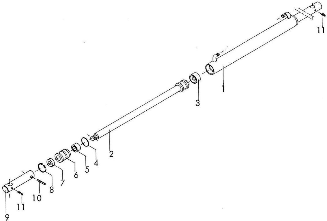
Gerätetyp: Zylinder  $\varnothing$  50 -doppeltwirkend- für SER 450,600
