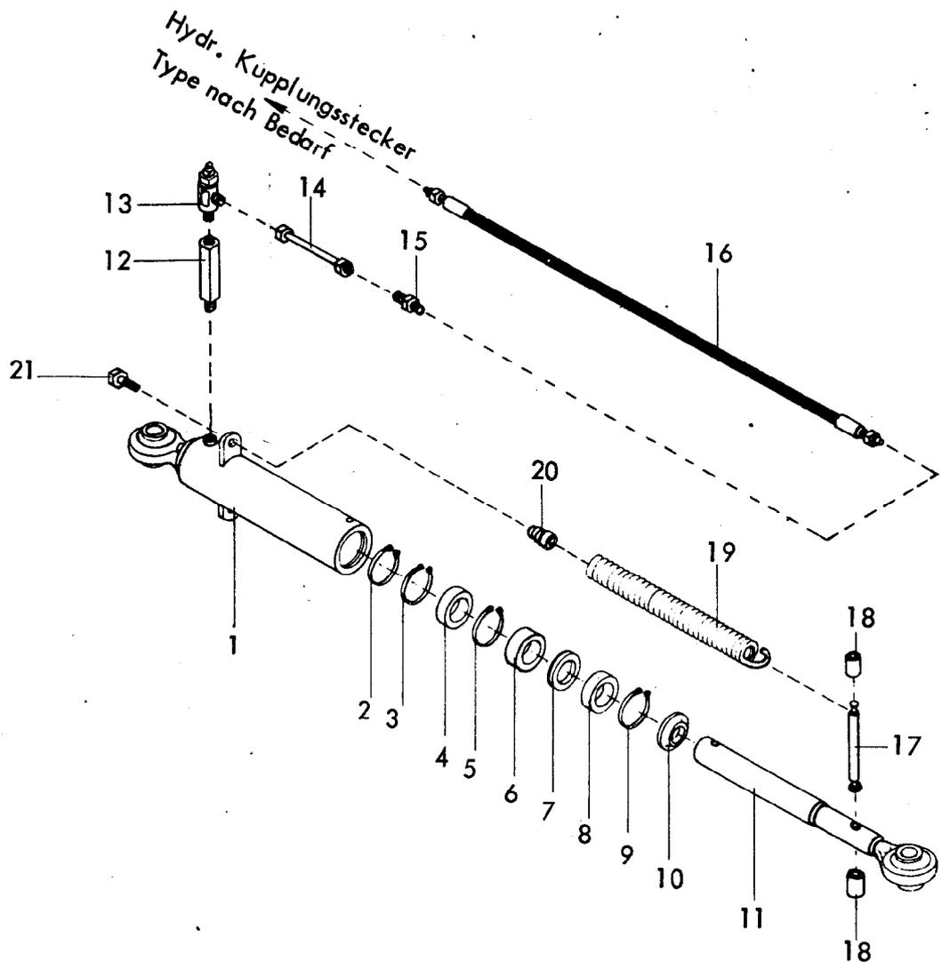
**Montage:** Sprengring 2 lose in das Zylinderrohr legen.
