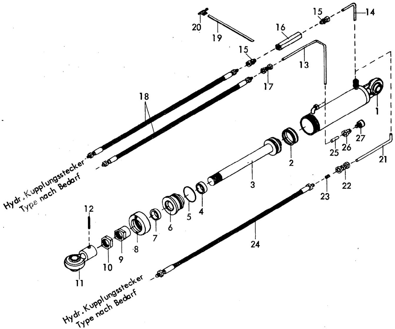
Gerätetyp: Ø 80 Hydraulikzylinder "E + D"
