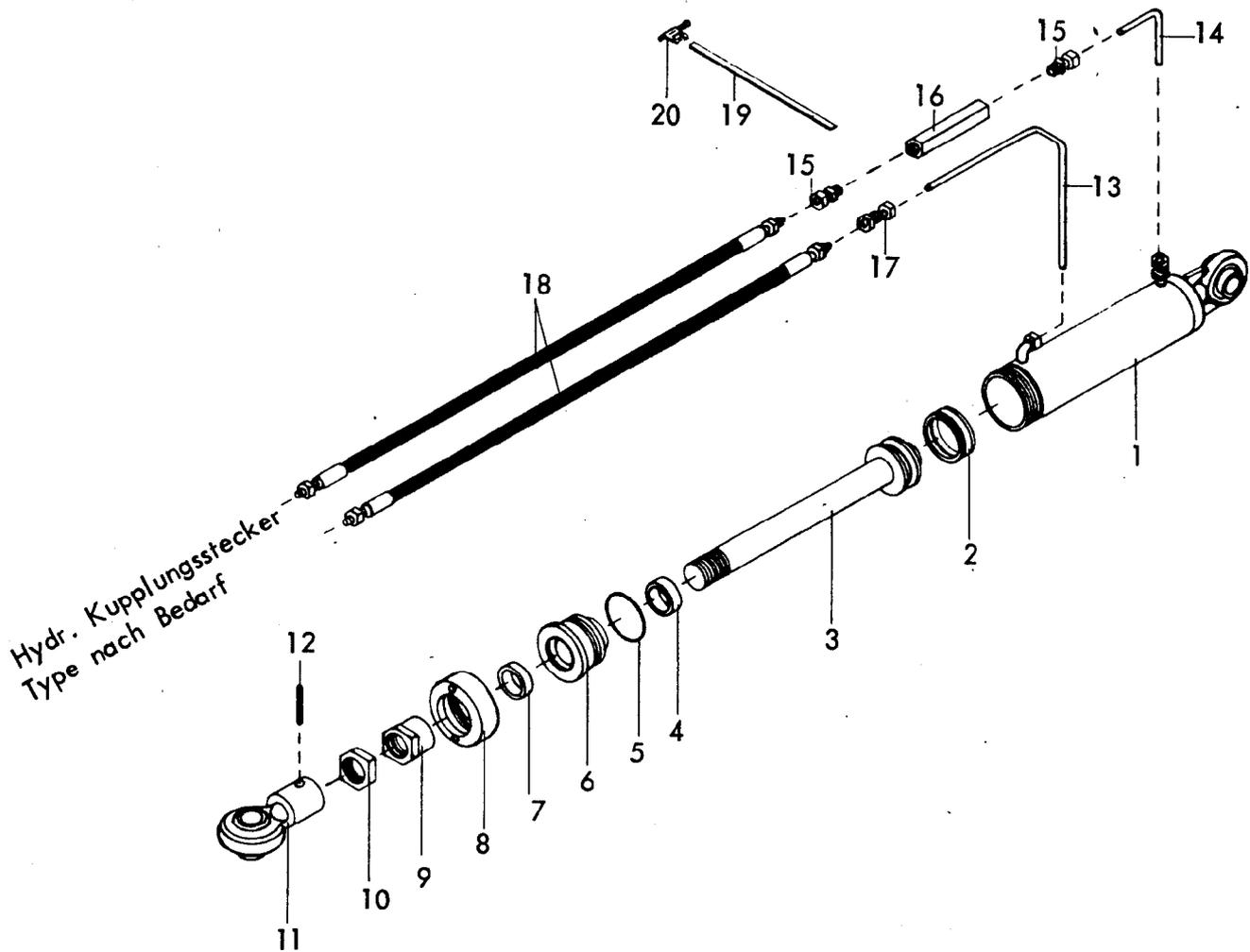
Gerätetyp: Ø 65 Hydraulikzylinder " D "
