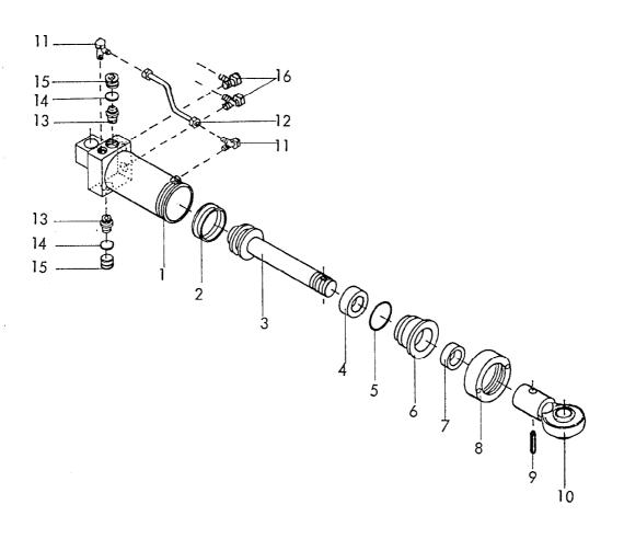
Gerätetyp: Schnittbreiten-Stellzylinder Ø 80 für Star-Variant,-Vari-Avant 140 Br. 2,
