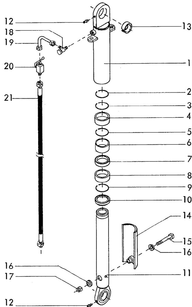
Montage : Sprengring 2 lose in das Zylinderrohr legen.
