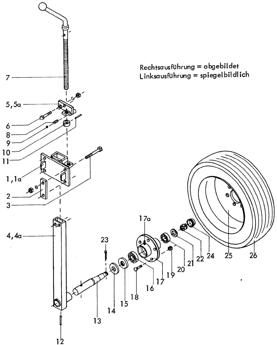
Gerätetyp: Stützräder -spindelverstellbar- für GK(F), FGK(F) 111, GR(F) 172
