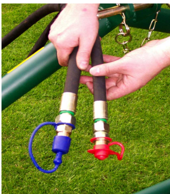
Abb. 4: Anschlussleitungen; Vor- und Rücklauf
