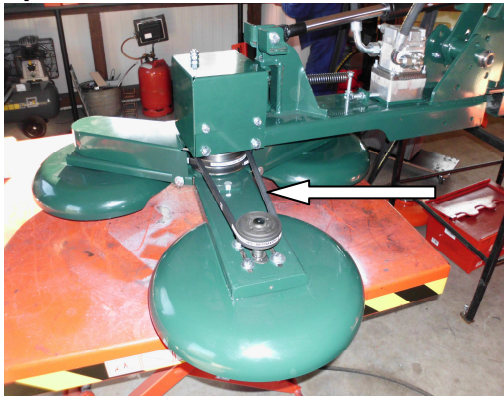
Abb. 26: Mäharm ohne Schutzabdeckung
