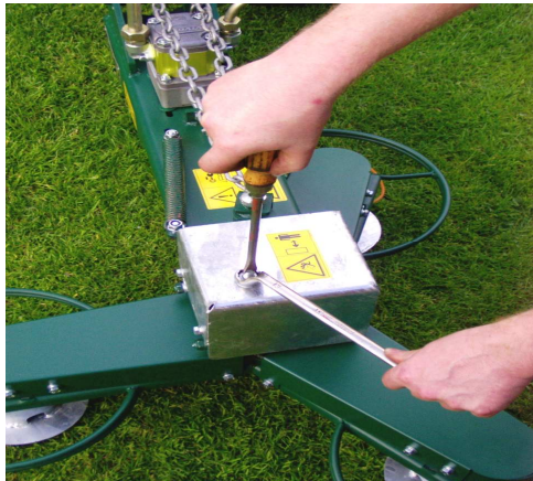
Abb. 17: Einstellen der Bremse
