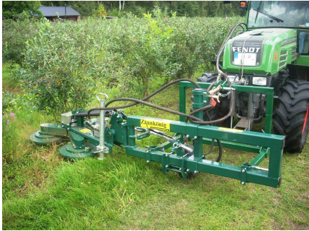
Abb.10: Mäher in Arbeitsstellung im Frontbetrieb
