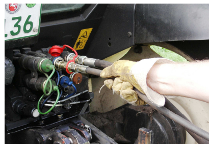
Abb. 8: Anschließen der Hydraulikleitung
