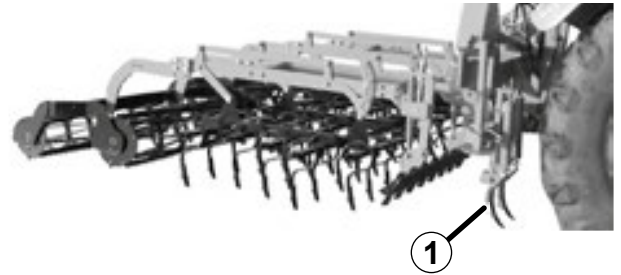
Abb. 73; Sturmvogel 9000 L Radspurlockerer hochstellen
