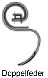
Abb. 96; Zinkenfeld Doppelfeder-, Vibrazinken
