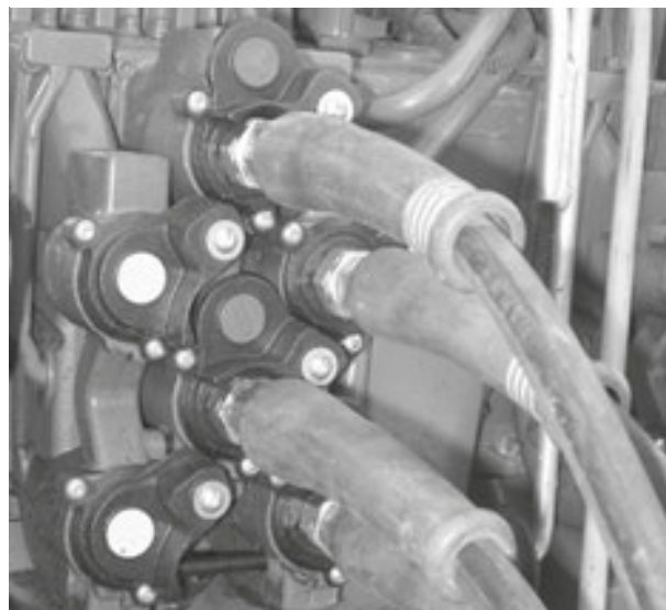
Fig. 84; Déconnexion des conduites hydrauliques
