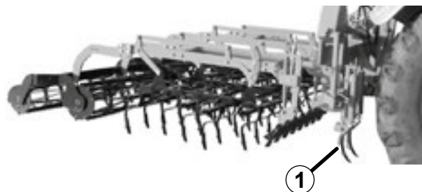
Fig. 73; Sturmvogel 9000 L Levage de l'efface-traces de roue
