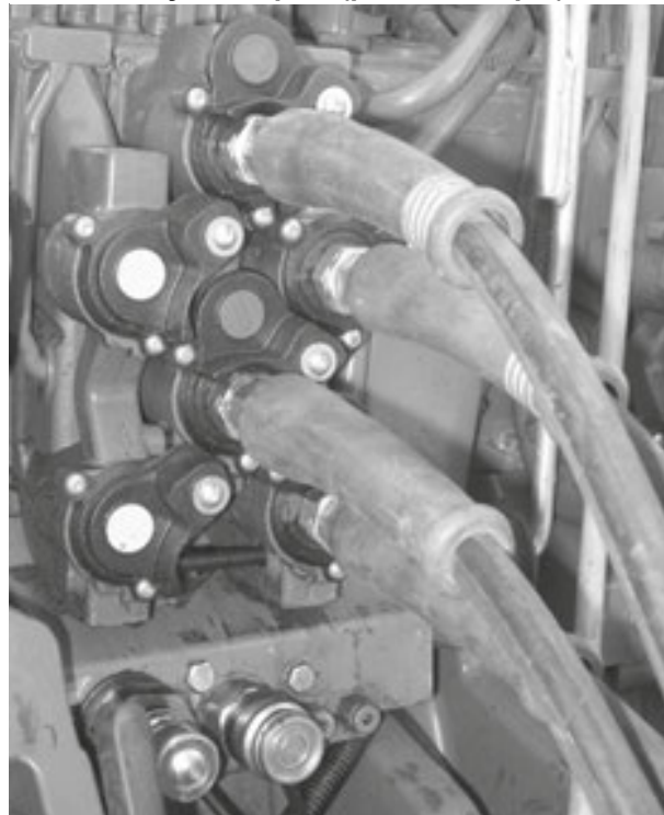
Fig. 45; Raccordement des conduites hydrauliques (photo exemple)
