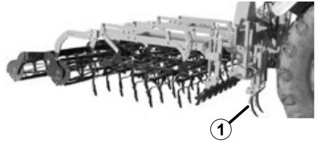
Fig. 73; Sturmvogel 9000 L Levage de l'efface-traces de roue
