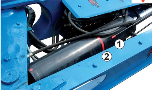
Das Steuergerät - grün - betätigen, bis der Parallelzylinder so weit ausgefahren ist, daß die Anzeigevorrichtung (1) den umlaufenden Markierungsring (2) am Parallelogrammzylinder erreicht. In dieser Position ist im Normalfall genügend Bodenfreiheit beim Wenden vorhanden.
