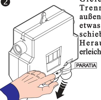
**3** Trennwand durch leichtes Drehen nach außen herausziehen.
