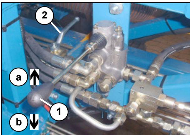
Schnecke anstellen, Hebel (3/1) in Mittelstellung bringen und Absperrhahn (3/2) öffnen.
