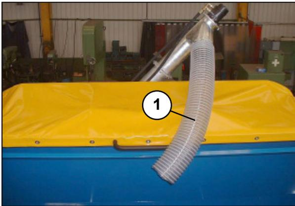
Den Tankdeckel öffnen und Befüllschlauch (2/1) in den Tank halten.
