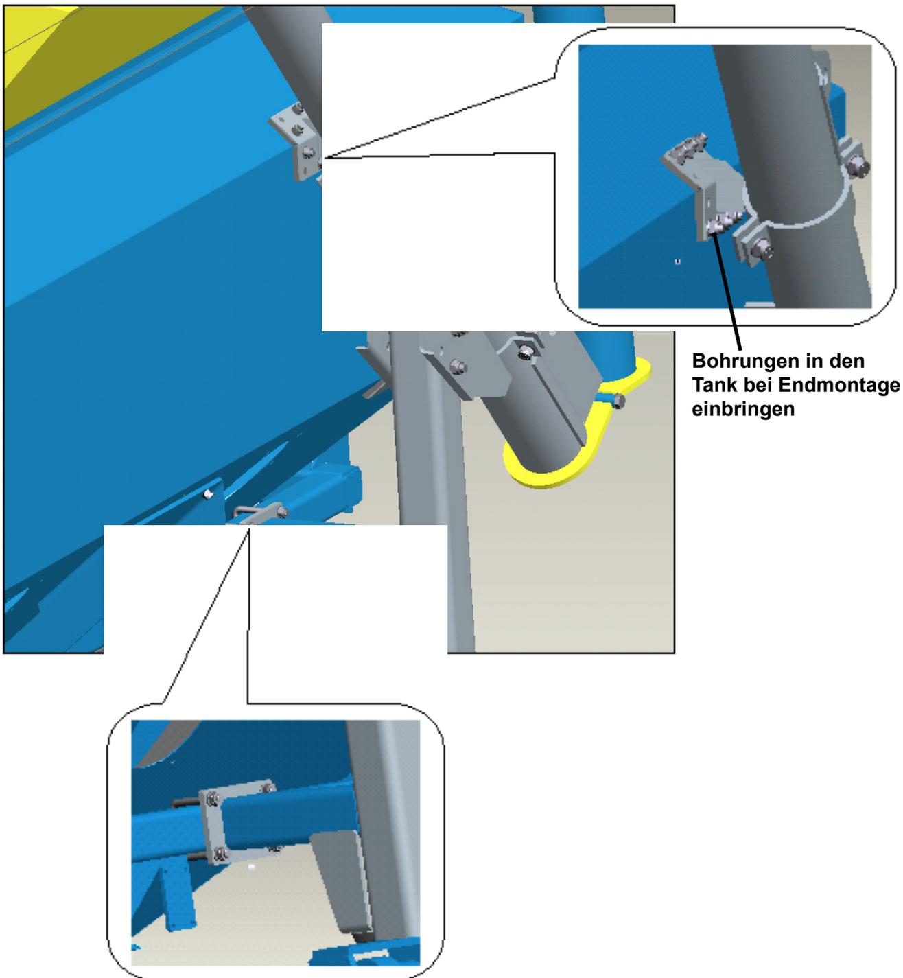
Die Platte mit der Bedienkonsole wird gemäß Foto montiert
