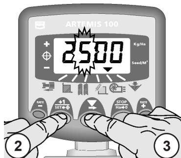
Abbildung 22: Alarm Gebläsedrehzahl ändern
